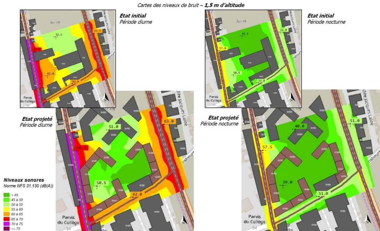
Figure 9 : Modélisation des niveaux de bruit à l'état initial et en phase projet à 1,5 m de hauteur (source : étude d'impact p. 359)
