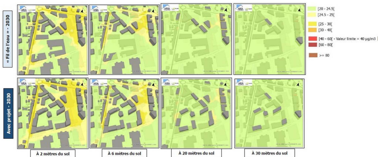
Figure 12 : Concentrations moyennes annuelles en NO 2 en fonction de l'altitude à horizon 2030 (source : étude d'impact p. 327)
