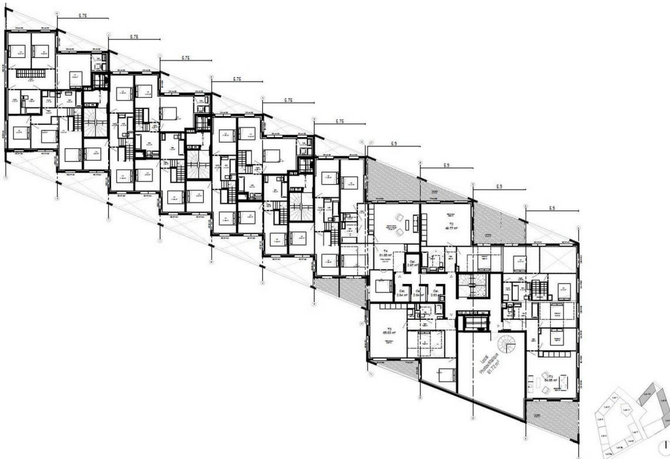
Figure 10 : Plan de masse du lot 8 et 9 (R+2) montrant de nombreuses chambres orientées sur l'avenue de l'Industrie génératrice de nuisances sonores (source : permis de construire, Annexes 1 - Lot 8_9_10 Plans 200)
